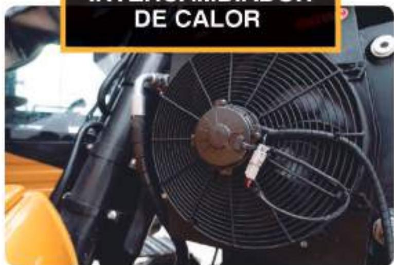
Mantener siempre el aceite hidráulico a temperatura ideal, lo que aumenta la vida útil de todo el sistema hidráulico y evita el sobrecalentamiento. Utilizamos cambiadores de alta eficiencia, los mismos que se utilizan en las cosechadoras de neumáticos.
