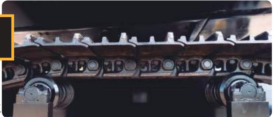
Originales de fábrica, los rodillos superiores tienen rodamientos dobles. La configuración alarga la vida útil de esta pieza, que también está estandarizada con las mismas especificaciones que los rodillos inferiores, que son extremadamente robustos.
