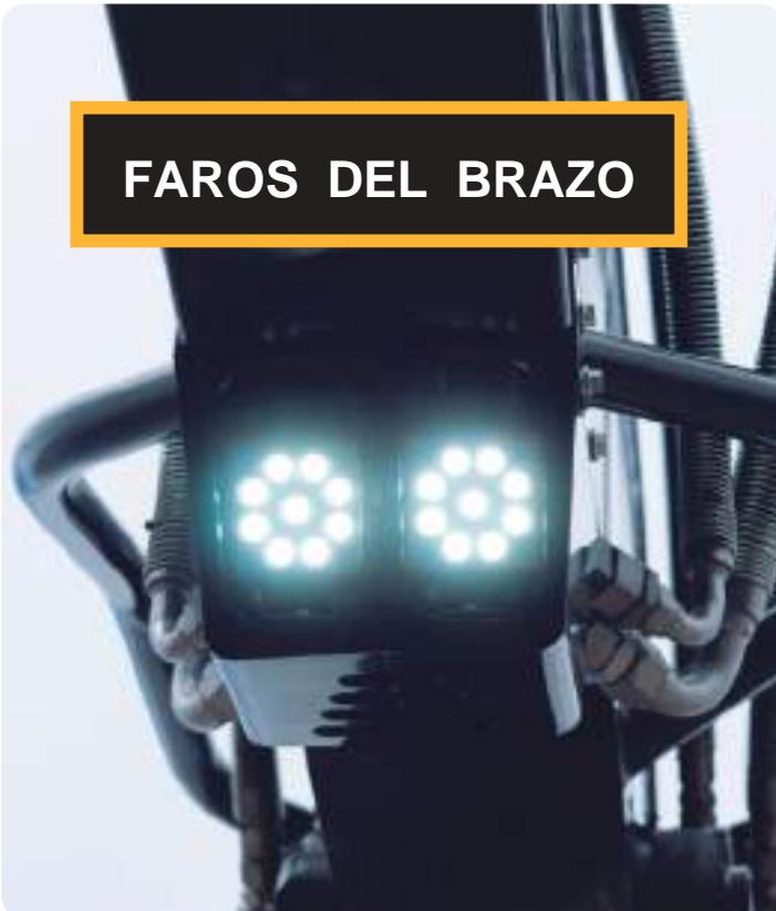
El conjunto desarrollado para proteger la tubería hidráulica también admite la instalación de dos faros y proporciona una mayor visibilidad al operador durante las actividades con iluminación reducida.
