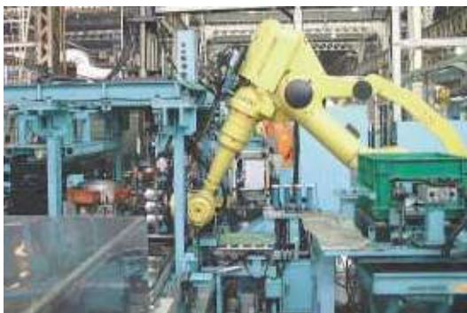
Línea automática de ensamble de pistones
